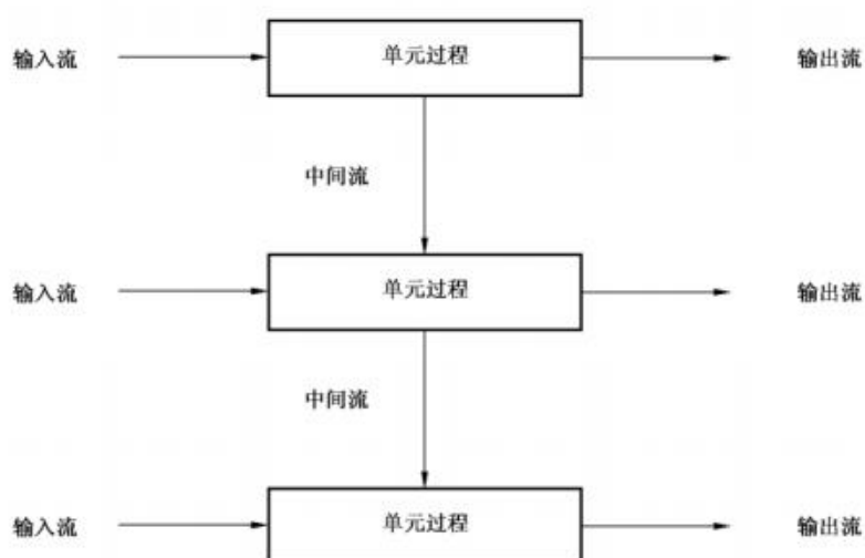
图 3 产品系统中一组单元过程的示例
